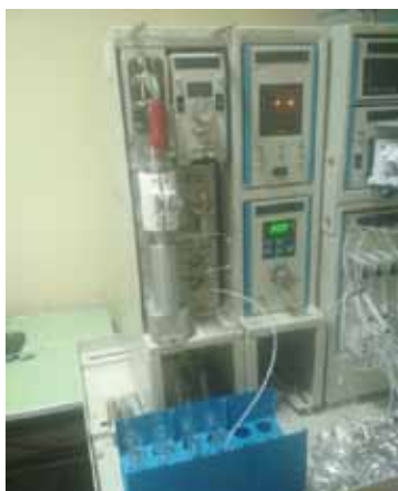
Рисунок 3 – система прискореної екстракції розчинником, реакційна комірка об'ємом 50 мл
