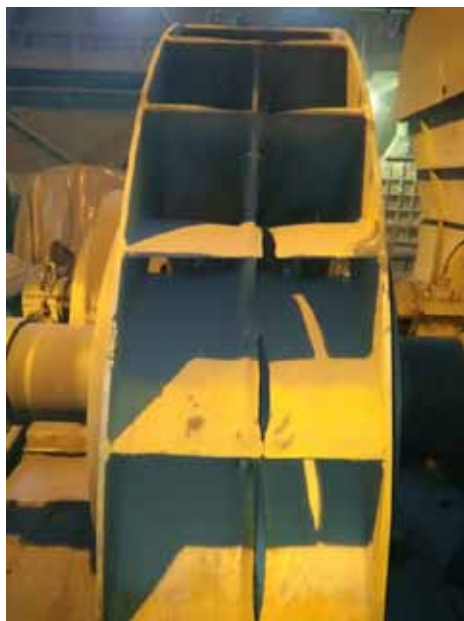
Рисунок 2. Пример износа колеса без защитных элементов
